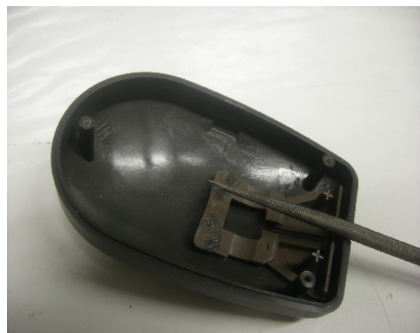
De behuizing aanpassen voor de nieuwe kabel
